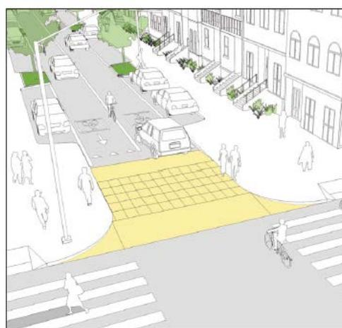
**L'Avanzamento del marciapiede** sulla carreggiata, sia su rettilineo che in corrispondenza delle intersezioni, permette una maggiore visibilità del pedone che si sta apprestando ad attraversare. Oltre a ridurre il tempo di attraversamento in carreggiata, può essere impiegato come elemento di *traffic calming* per creare restringimenti di carreggiata e, quindi, moderare la velocità dei veicoli.
