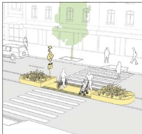
**L'attraversamento pedonale rialzato** consiste in una sopraelevazione della carreggiata, realizzata per dare continuità (di quota) al marciapiede, in corrispondenza di un attraversamento. È da rilevare che la larghezza della pavimentazione rialzata deve essere dimensionata rispetto alla lunghezza dei veicoli che vi transitano. Tale configurazione sancisce anche fisicamente la precedenza del pedone rispetto al veicolo e funge da elemento di moderazione della velocità per i veicoli.
